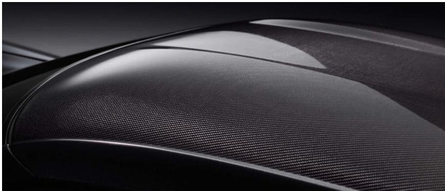
Fronthaube und abnehmbares Hardtop aus Carbon
